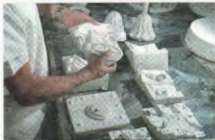
Ouverture des moules en plâtre.
