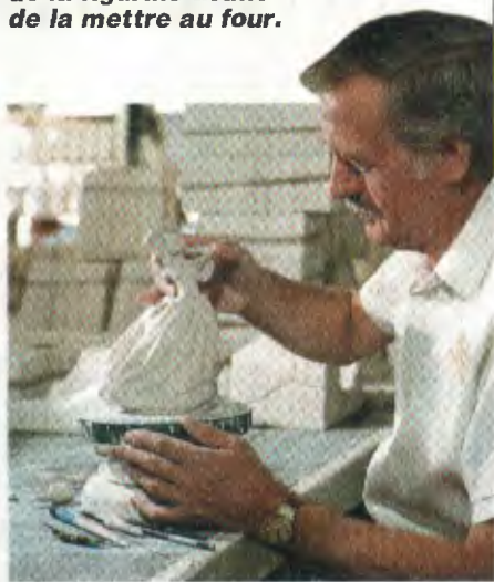
L'assembleur fixe les différentes parties de la figurine avant de la mettre au four.
