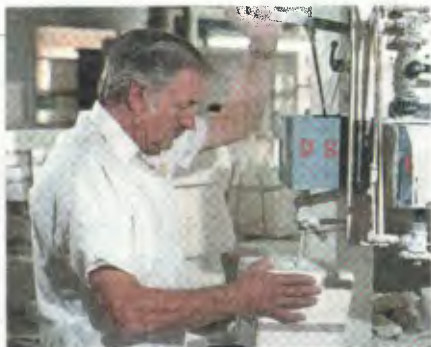
La barbotine se déverse du pétrin dans un moule en plâtre.
