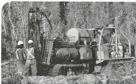
On se sert d'engins spécifiques pour générer des ondes sonores qui vont se réfléchir dans des capteurs.
